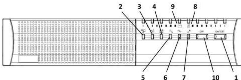
**1 Кнопка "ON / TEST"** Після підключення ДБЖ до електромережі натисніть кнопку ON / TEST для включення ДБЖ і живлення обладнання. При включеному ДБЖ натискання кнопки ON / TEST активує функцію вбудованого контролю (самодіагностики) ДБЖ.
